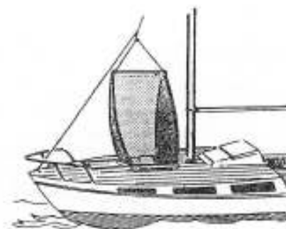
Rys.10.3. Taki oto „supernawiewnik” pozwala na sprawne przewietrzenie wnętrza jachtu.
