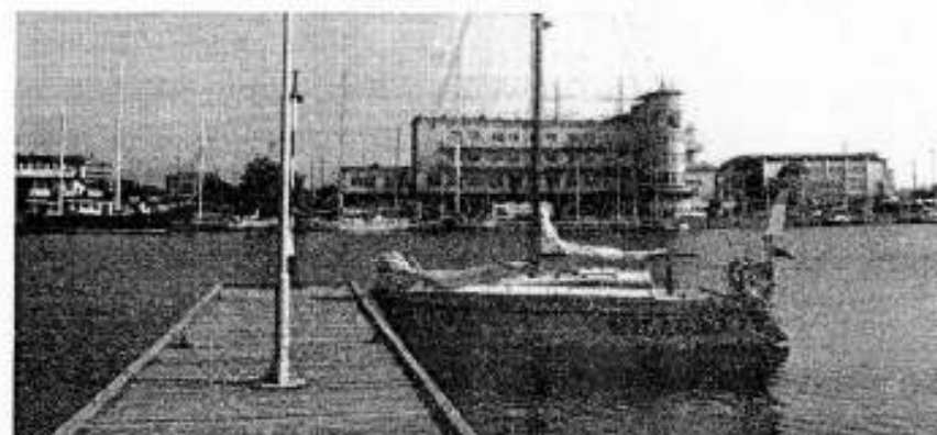
Rys.2.4. Laminatowy, balastowo-mieczowy jacht „Milagro IV”. Długość całkowita 8,25 m. Projekt - Jerzy Maćkowiak, budowa - autor.
