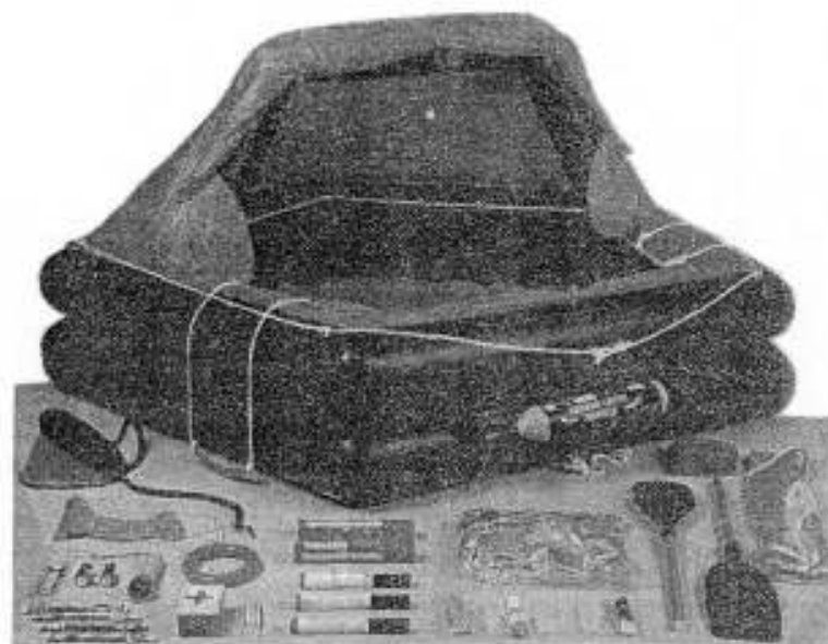
Rys. 14.10. Czteroosobowa tratwa jachtowa i jej pełnowyposażenie
