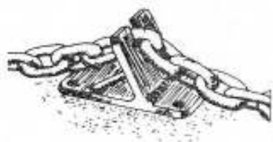
Rys. 13.5. Prosty pokładowy stoper łańcucha kotwicznego
