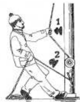
Rys. 12.4. „Pompowanie” fału - zastępuje użycie korby kabestanowej.
