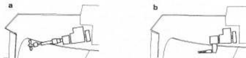
Rys. 4.51. Wyrowadzenie napędu. Wałem skośnym, bezpośrednim (a), przekładnią kątową „S-drive” (b)
