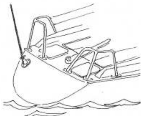
Rys.22.4. Antena pawężowa CB Radio na małym jachcie. Podczas strojenia może się okazać konieczne lekkie odchylenie anteny do tyłu. Jest to wpływ takielunku i kosza.
