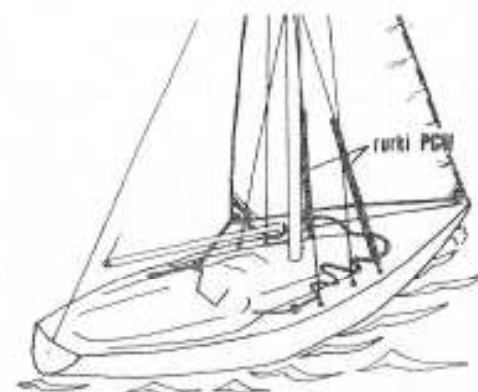
Rys. 4.39. Plastikowe rurki na przednich wantach kolumnowych to przedłużenie życia sztakłom i ich szotom oraz bardziej „gładkie” przechodzenie żagli przy zmianie halsu.
