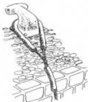
Rys. 10.9. Tak zabezpieczone cumy będą służyć latami
