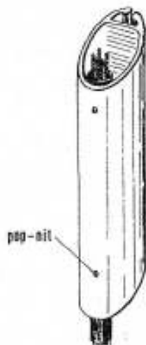
Rys.22.1. Najkorzystniej jest poprowadzić wszystkie kable rurą z PCW
