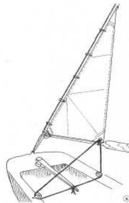
Rys. 9.3. Baksztagową żeglugę pod fokiem i grotem (zakontrowanym) umożliwia zaimprovizowany płat wiatrowy, którego udaje sztormowy foczek, podniesiony topenantą na achtersztagu. Rolę bomu spełniać może pagaj lub bosak.
