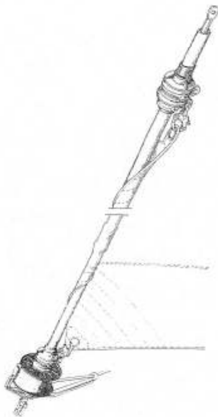
Rys. 12.1. Rolfok o nieskręcającej się owiewce, obracającej się wokół sztagu.
