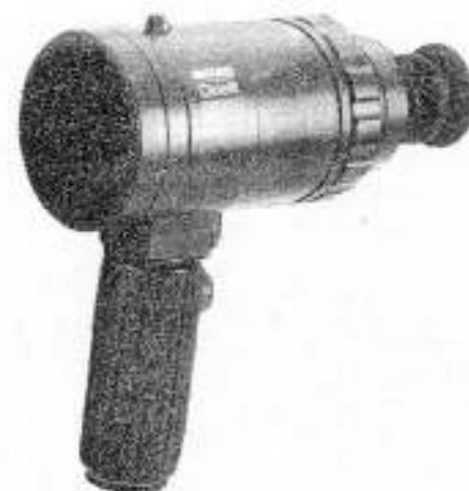
Rys. 7.14. Noktowizor „Vetus-Oldelft PM5FG”. Dane techniczne: przybliżenie - 5x, rozjaśnienie - 250 do 600x, dostrojenie ostrości wzroku - +/- 4 dioptrie, głębia ostrości - 10m - oo, zasilanie - 2 baterie 1,5 V (AA), masa - 1,2 kg.
