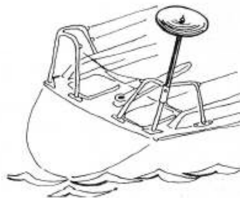
Rys. .20.2. „Talerzowa” antena telewizyjno - radiowa nie reaguje na halsówkę
