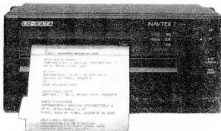
Rys. 20.4. Radioteleks pogodowy z wydrukiem na papierze - „Navtex-2” firmy LO-KATA. Zapotrzebowanie energii podczas nasłuchu - 0,1A, podczas wydruku - 1,0A.
