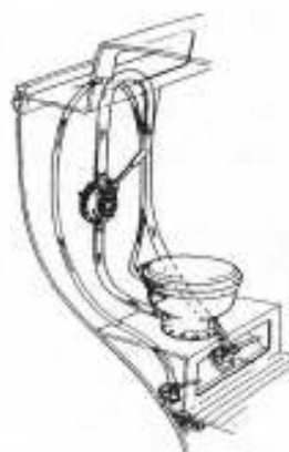
Rys. 4.48. Syfonowe przewody zasilania i odpływu toalety zaburtowej
