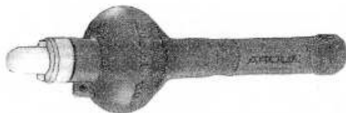
Rys. 14.5. Pławka świetlna „Argus” firmy McMurdo-Marine. Masa z bateriami - 445 gramów, światło błyskowe, czas świecenia 2 godziny, jasność światła 2 cande, cena 1,5 mln zł (1994).
