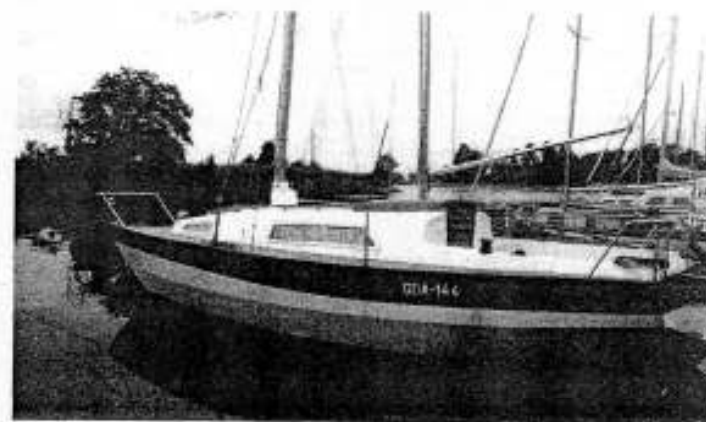
Rys. 2.1. Laminatowy, siedmiometrowej długości jacht „Alek” - zaprojektowany i zbudowany przez Sławomira Czółczyńskiego. Ciekawostką techniczną jest to, że kadłub wylaminowano w jednorazowej formie
