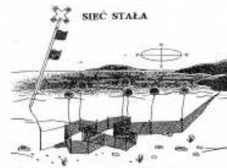
Rys.26.6 Najważniejsze przykłady (nowego – od 1994 r) oznakowania szwedzkich narzędzi połowowych. Objaśnienia skrótów na rysunkach: L – folia odbłaskowa żółta, T – kula, jako znak szczytowy, odbłaskowa, R – reflektor radarowy, kL – krzyż, jako znak szczytowy, żółty, odbłaskowy.
