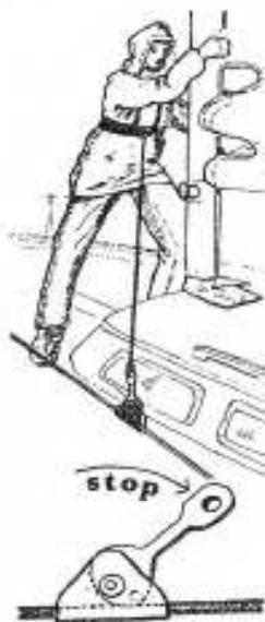
Rys. 4.17. Stoper zaczepu karabińczyka pasa bezpieczeństwa. To proste i bardzo praktyczne urządzenie może być wykonane przez każdego majsterkowicza.
