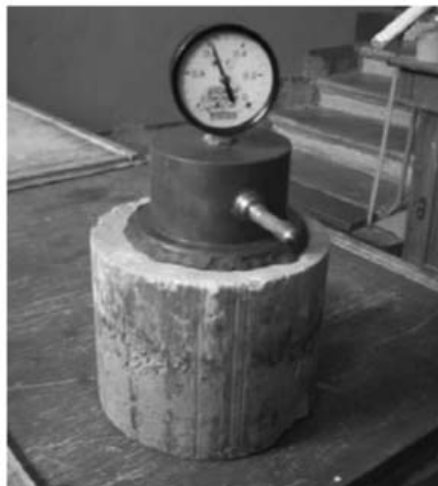
Рис.3. Пристрій ВВ-2 прискореного визначення водонепроникності
