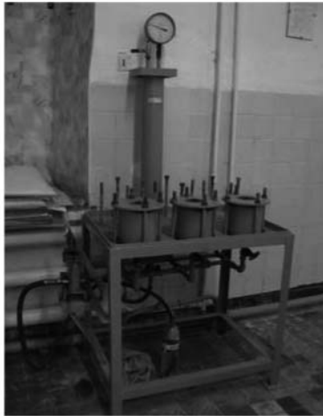
Рис.2. Установка для випробувань зразків методом «мокрої плями»
