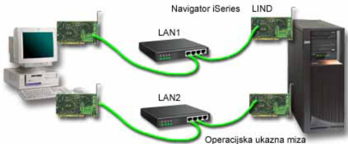
3. slika Konfiguracija Navigatorja iSeries in operacijske ukazne mize v ločenih omrežjih
