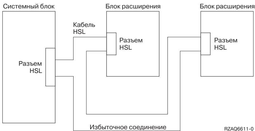
Рисунок 2. Планирование резервного канала связи с двумя блоками расширения
