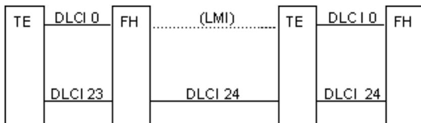
Рисунок 5. Пример DLCI, назначенных соединениям PVC
