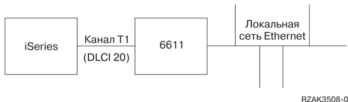
Рисунок 12. Настройка комплексной сети Frame Relay/Ethernet
