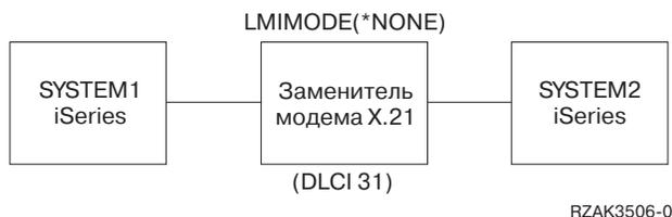
Рисунок 9. Прямое соединение SNA с использованием заменителя модема
