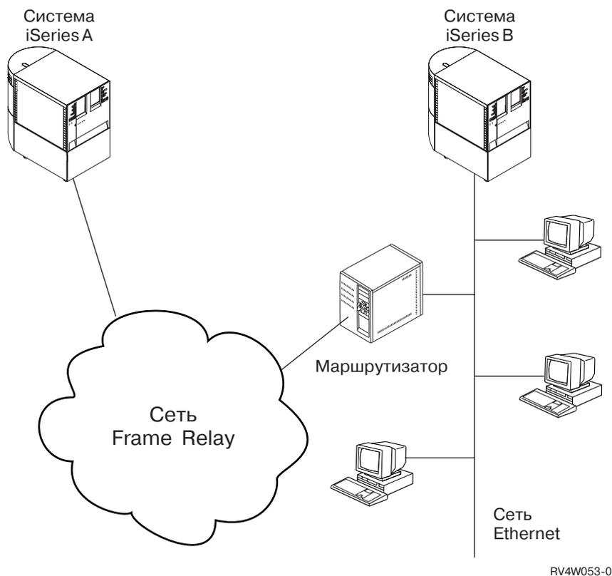
Рисунок 2. Пример комплексной сети Frame Relay
