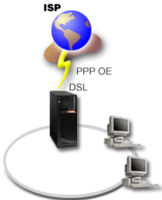
Рисунок 1. Подключение сервера iSeries к ISP с помощью PPPoE
