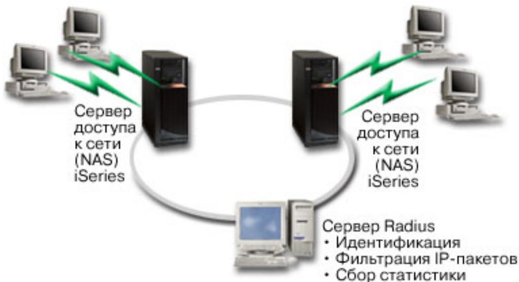
Рисунок 5. Идентификация коммутируемых соединений с помощью сервера RADIUS
