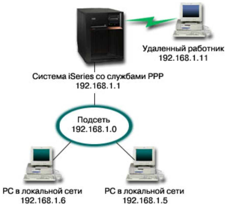
Рисунок 2. Подключение удаленных клиентов к серверу iSeries
