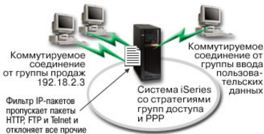
Рисунок 6. Применение параметров соединения к коммутируемым соединениям на основе групповых стратегий
