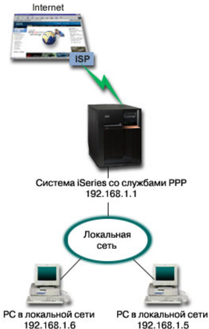
Рисунок 3. Подключение локальной сети к Internet с помощью модема
