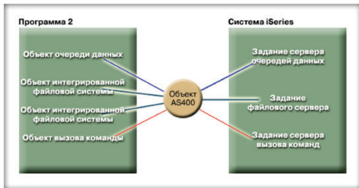
Рисунок 2: Создание одного объекта AS400 и одного соединения с сокетами iSeries в программе на Java
