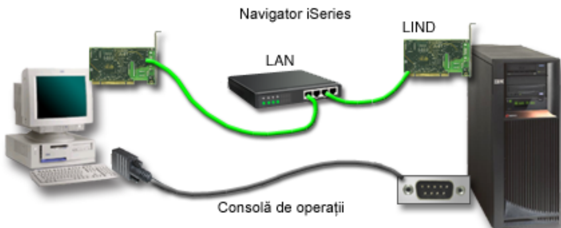
Figura 1. Configurare Navigator iSeries și Consolă de operații pe conectivități separate
