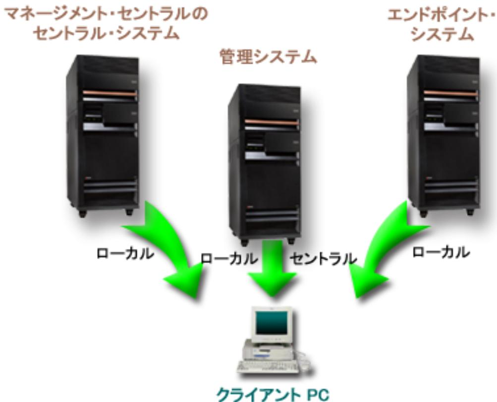
図2. クライアント PC がシステムに接続する場合、接続するシステムからローカル設定が送信される。管理システムに接続する場合には、セントラル設定は管理システムからクライアント PC に送信される。このネットワークでは、アプリケーション管理またはマネージメント・セントラルの機能は変更されない。
