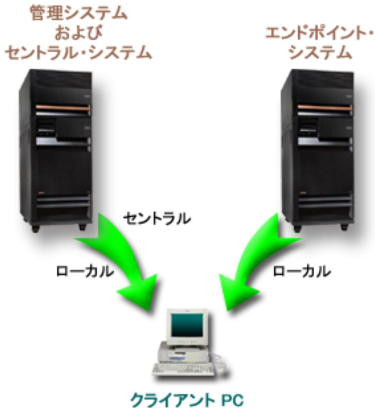
図3. 管理システムとセントラル・システムを同じシステムにすることができる。これにより、アプリケーション管理またはマネージメント・セントラルの機能を変更されることはない。クライアント PC がシステムに接続する場合、接続するシステムからローカル設定が送信される。管理システムに接続する場合には、セントラル設定は管理システムからクライアント PC に送信される。
