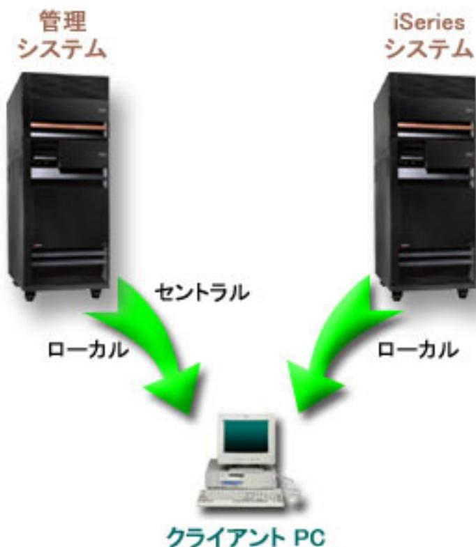
図1. クライアント PC がシステムに接続する場合、接続するシステムからローカル設定が送信される。管理システムに接続する場合には、セントラル設定は管理システムからクライアント PC に送信される。
