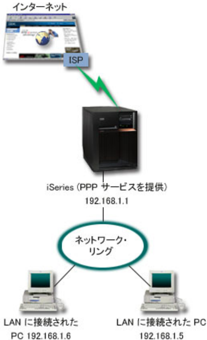
図3. モデムを使用してオフィスの LAN をインターネットに接続する
