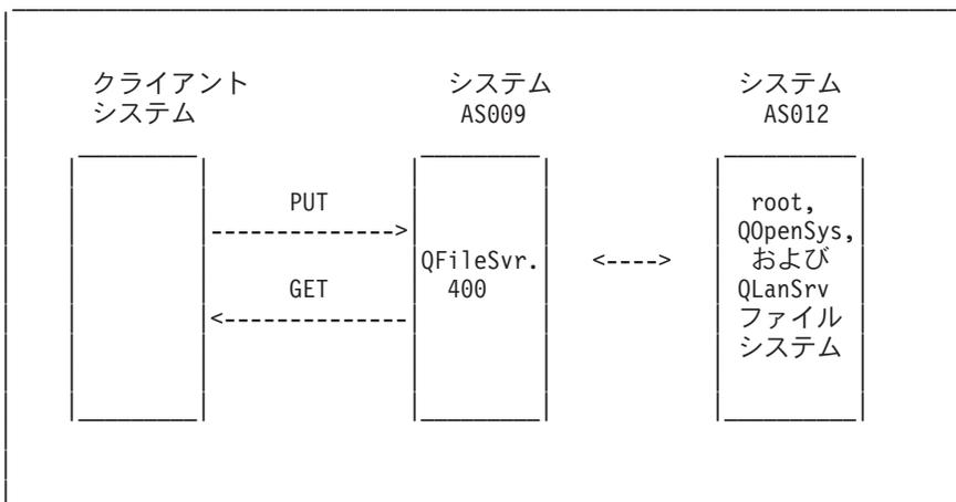
図 9-31. QFileSvr.400 を使用してファイルを転送するためのサブコマンド
