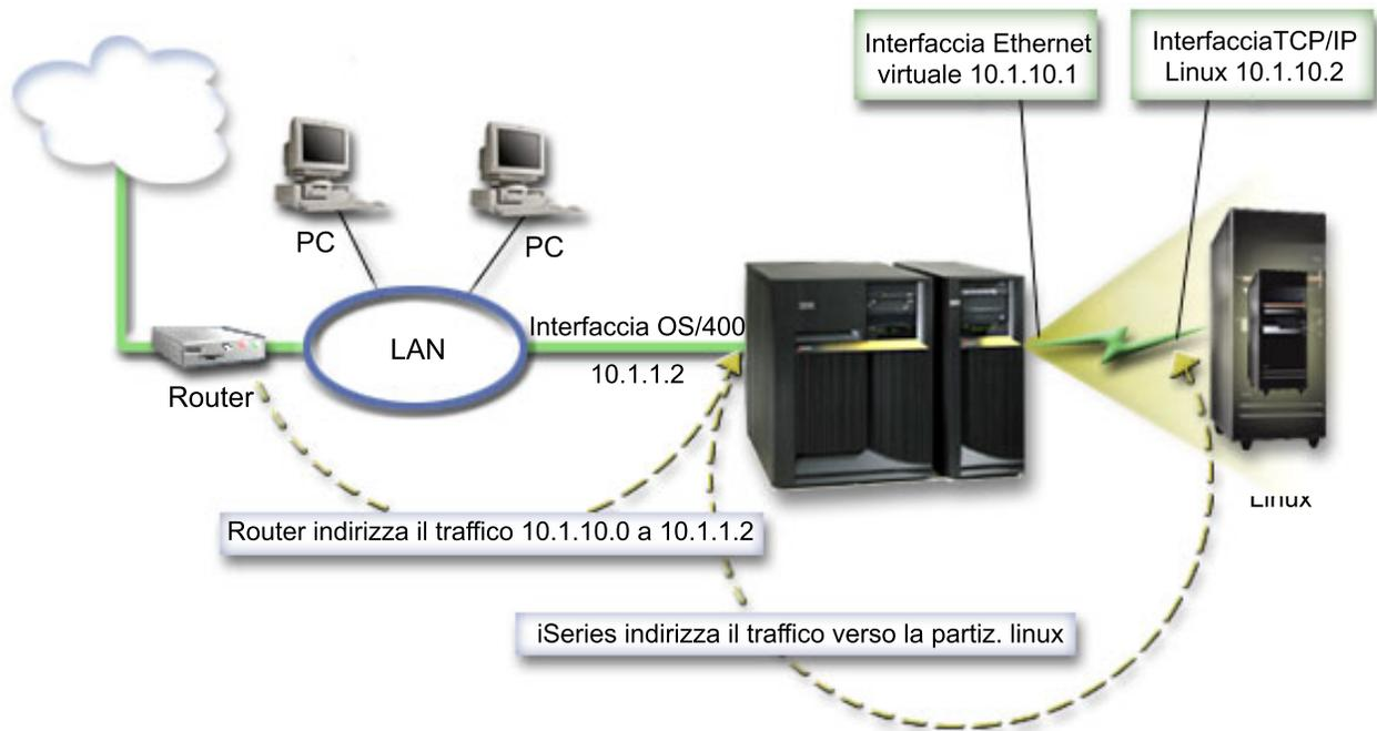
L'interfaccia TCP/IP esistente (10.1.1.2) si collega alla LAN. La LAN è collegata alle reti remote con un router. L'interfaccia TCP/IP di Linux viene indirizzata come 10.1.10.2 e l'interfaccia TCP/IP Ethernet virtuale come 10.1.10.1. In OS/400, se si attiva l'Inoltro datagramma IP, iSeries instraderà i pacchetti IP sulla e dalla partizione logica. Quando si definisce il collegamento TCP/IP di Linux, l'indirizzo del router deve essere 10.1.10.1.
