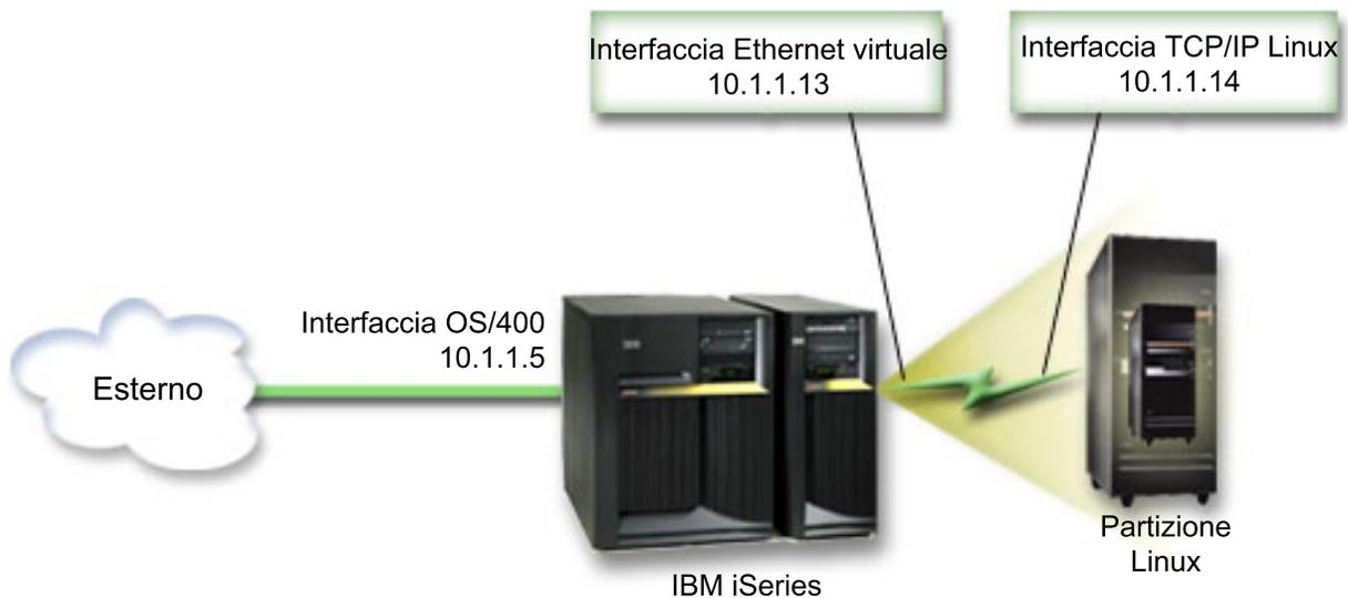
In questo esempio viene utilizzato un blocco contiguo di quattro indirizzi IP, che è 10.1.1.12 - 10.1.1.15. Poiché si tratta di un blocco di quattro indirizzi IP, la maschera di sottorete relativa a questi indirizzi è 255.255.255.252. Per configurare un'impostazione simile a questa, utilizzare le istruzioni seguenti:
