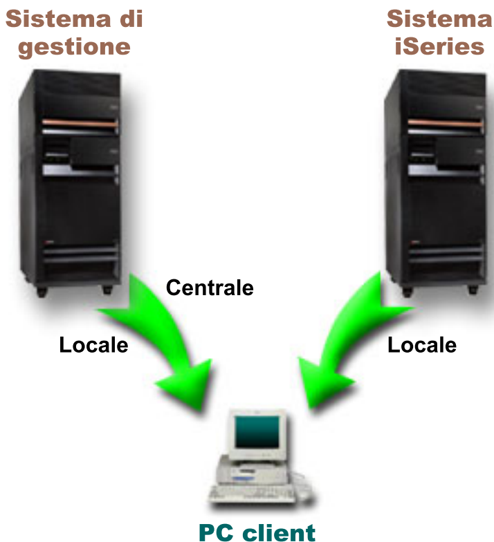
Figura 1. Quando un PC client si collega ad un sistema, le Impostazioni locali vengono dal sistema a cui ci si collega. Quando si effettua il collegamento ad un sistema di gestione, le Impostazioni centrali vengono inviate al proprio PC client dal sistema di gestione.
