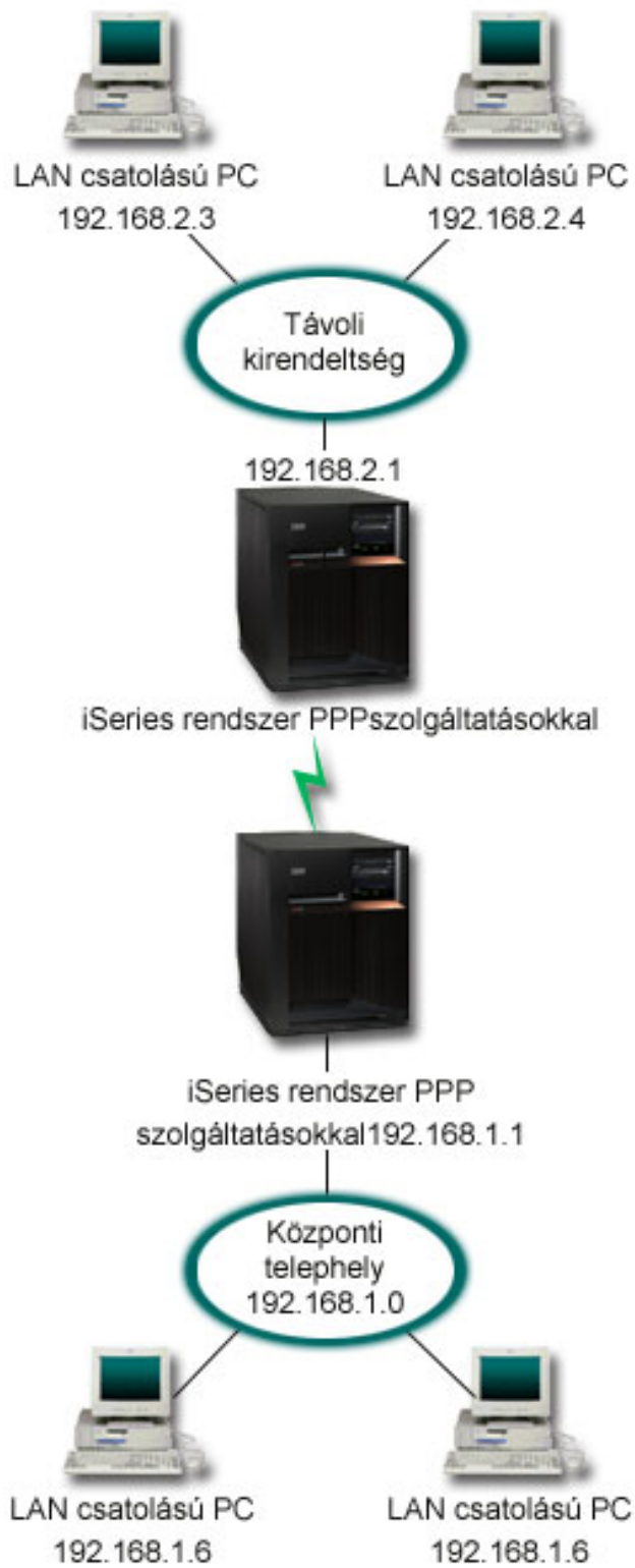
4. ábra: A vállalati és a távoli hálózatok összekapcsolása modemmel
