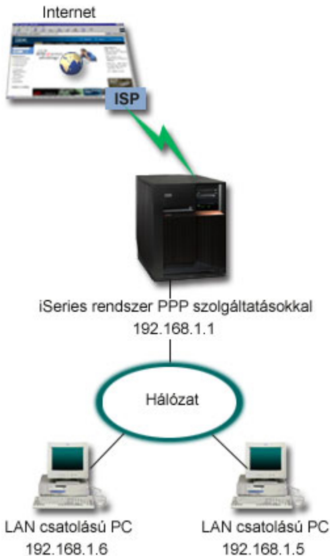
3. ábra: Az irodai LAN kapcsolódása az Internethez modem segítségével
