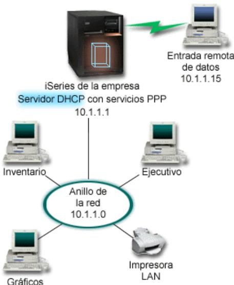
Para que el empleado remoto sea un miembro efectivo de la red de la empresa, el servidor iSeries debe utilizar una combinación de Servicios de acceso remoto y DHCP. La función de Servicios de Acceso Remoto crea la posibilidad de marcación para el servidor iSeries. Si está configurado correctamente, una vez que el empleado establece la conexión por marcación, el servidor PPP indica al servidor DHCP que distribuya la información TCP/IP al empleado.
