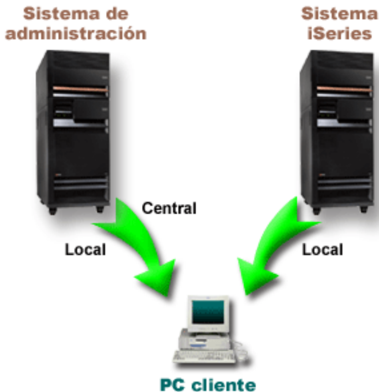
Figura 1. Cuando un PC cliente se conecta a un sistema, los valores locales proceden del sistema al que se haya conectado. Si usted se conecta a un sistema de administración, los valores centrales se envían desde el sistema de administración a su PC cliente.
