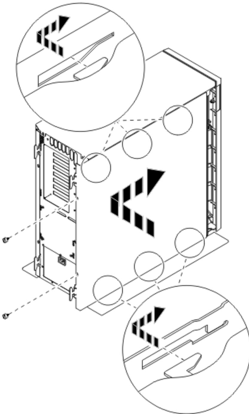
Figura 3. Colocación de la cubierta lateral de la unidad del sistema
