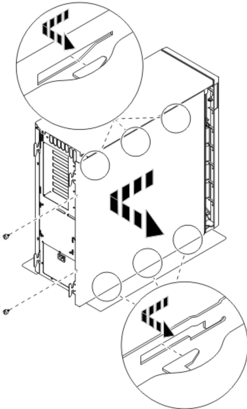
Figura 1. Extracción de la cubierta lateral de la unidad del sistema
