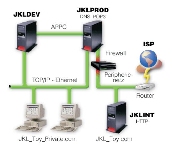
Wie aus dem Diagramm ersichtlich, verfügt das Unternehmen JKL Toy über zwei primäre iSeries-Server. Ein System wird für Entwicklungsanwendungen, das andere für Produktionsanwendungen (JKLDEV bzw. JKLPROD) eingesetzt. Da auf beiden Systemen unternehmenskritische Daten und Anwendungen verarbeitet werden, gibt es Bedenken, die Internetanwendungen ebenfalls auf diesen Systemen auszuführen. Stattdessen soll ein neuer iSeries-Server (JKLINT) hinzugefügt werden, auf dem diese Anwendungen laufen sollen.
