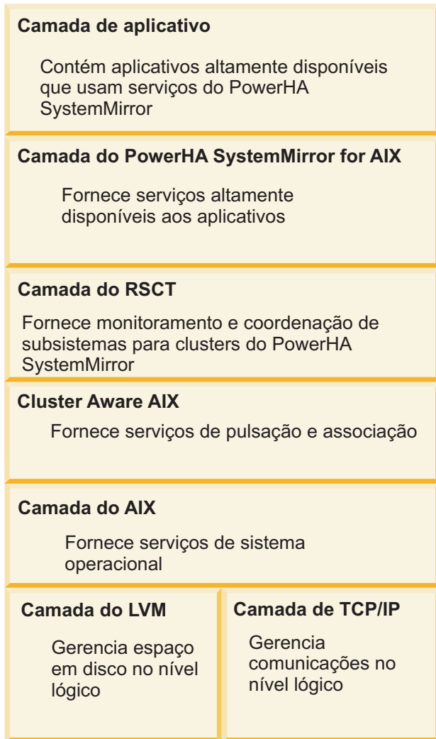
Figura 7. Modelo de um nó do cluster do PowerHA SystemMirror
