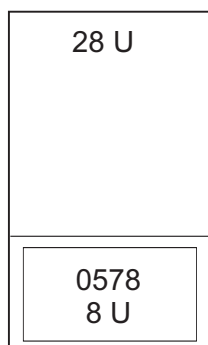
Slika 12. Koda možnosti 0578 - razširitvena enota PCI-X v omari
