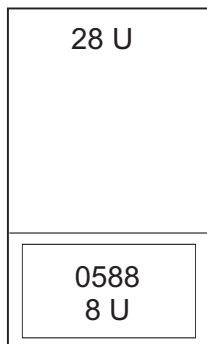
Slika 20. Šifra komponente 0588 - PCI-X jedinica proširenja u stalku
