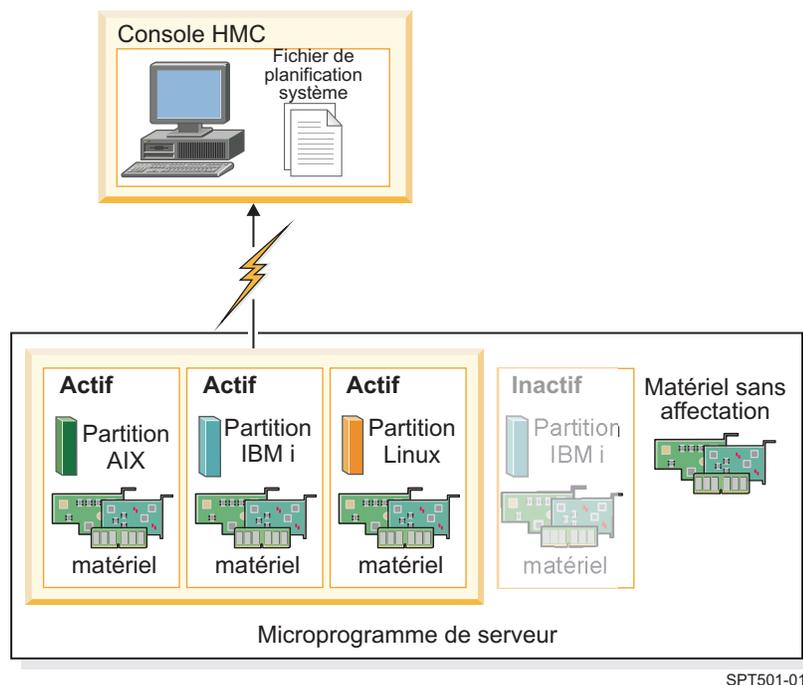
Sur ce schéma, les informations concernant les partitions AIX, IBM i et Linux actives sont collectées et placées dans un fichier de planification système sur la console HMC. Le processus ne collecte pas les informations concernant le matériel alloué à la partition IBM i inactive et au matériel non alloué à une partition.
