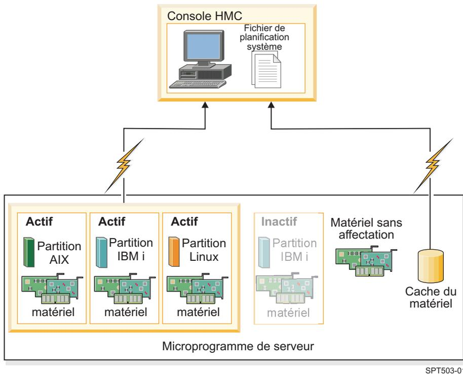
Dans le schéma, la console HMC utilise le processus de collecte d'inventaire uniquement pour collecter des informations sur la partition inactive et le matériel qui lui est affecté. La console HMC complète la planification système à l'aide des informations sur le matériel provenant du cache d'inventaire pour les partitions logiques actives du serveur géré.
