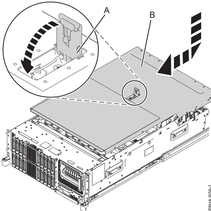
Figure 44. Installation du capot d'accès
