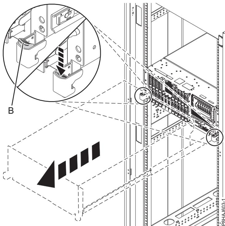
Figure 51. Déblocage des loquets latéraux
