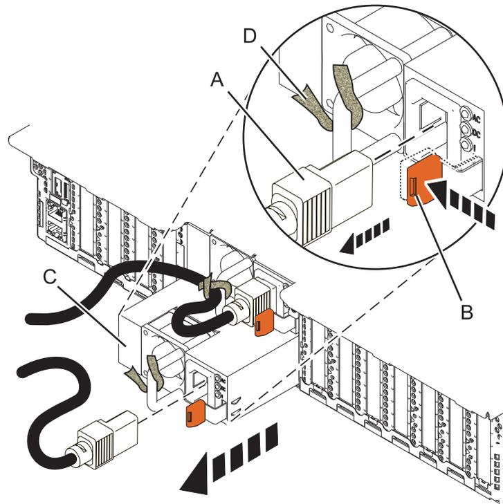
Figure 10. Retrait d'un bloc d'alimentation du système
