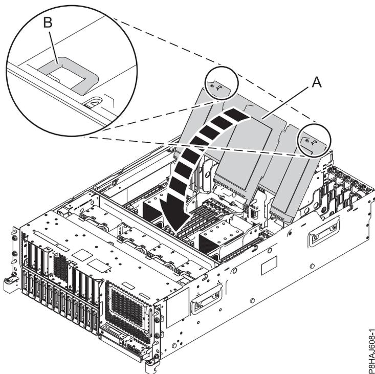
Figure 47. Fermeture du déflecteur d'air
