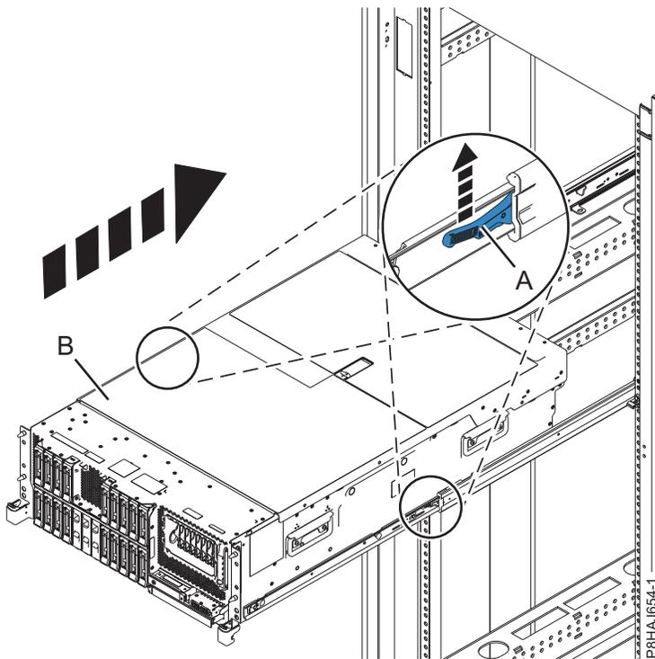
Figure 52. Mise en position de fonctionnement du système
