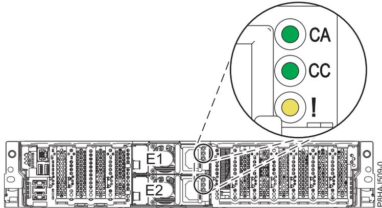
Figure 7. Emplacement des blocs d'alimentation et des voyants dans le système
