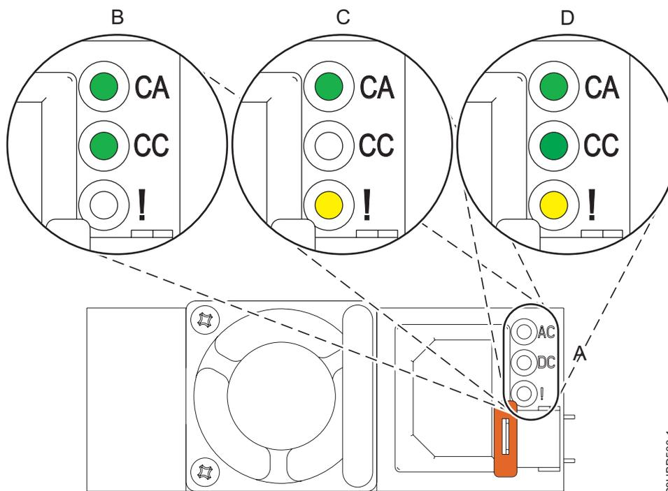
Figure 6. Voyants pour un bloc d'alimentation opérationnel et défaillant
