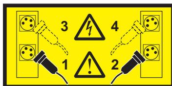
**PELIGRO:** Varios cables de alimentación. Este producto puede estar equipado con múltiples cables de alimentación. Para evitar todo voltaje peligroso, desconecte todos los cables de alimentación. (L003)
