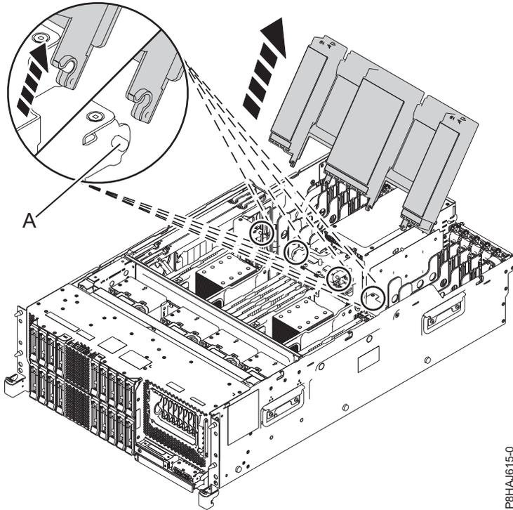
Figura 46. Extracción del deflector de aire
