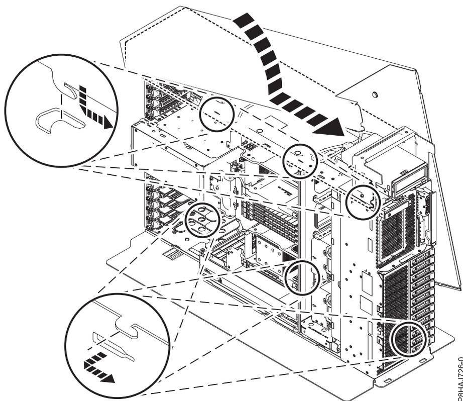
Figura 38. Colocación de la cubierta lateral de 8286-41A
