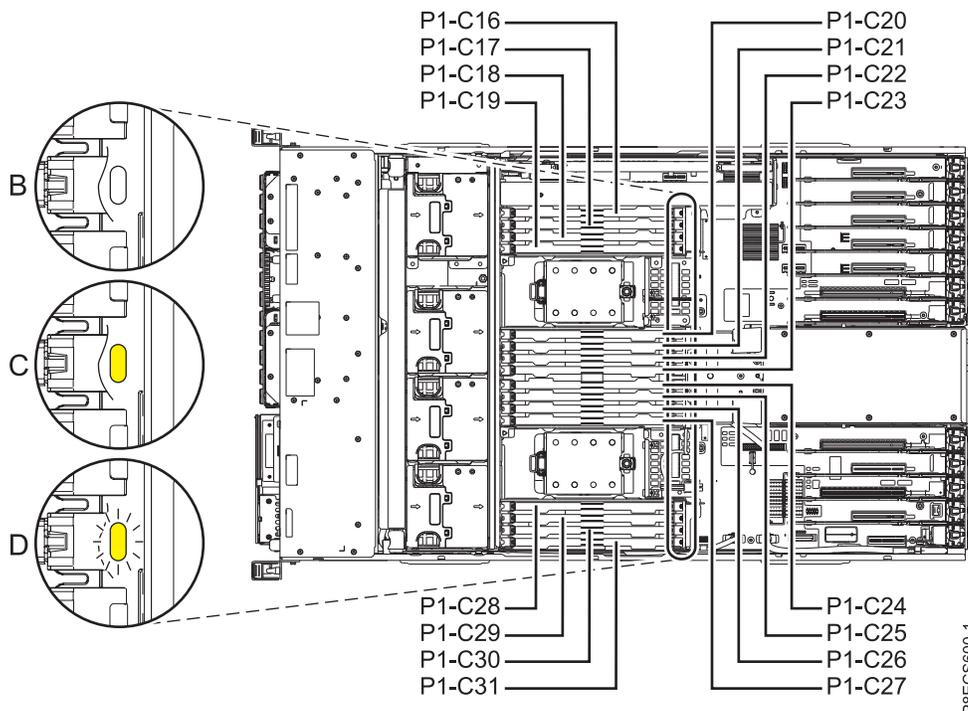
Figura 1. Ubicaciones de módulos de memoria e indicadores de servicio del sistema 8247-42L, 8286-41A o 8286-42A
