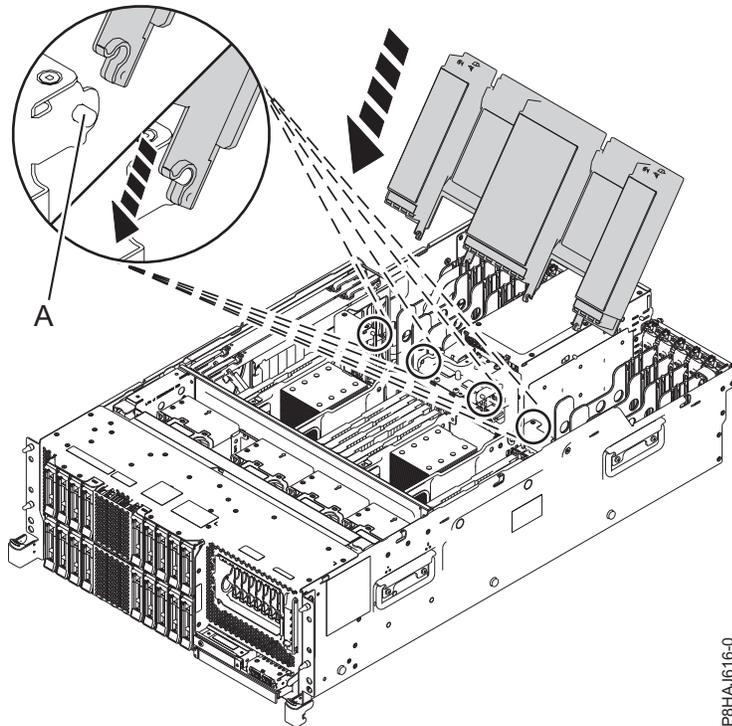
Figura 47. Sustitución del deflector de aire
