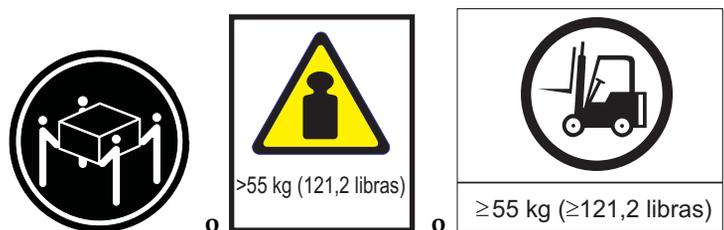
Esta pieza o unidad pesa más de 55 kg (121,2 libras). Se necesitan profesionales especializados y/o un dispositivo de elevación para levantar sin peligro esta pieza o unidad. (C011)
