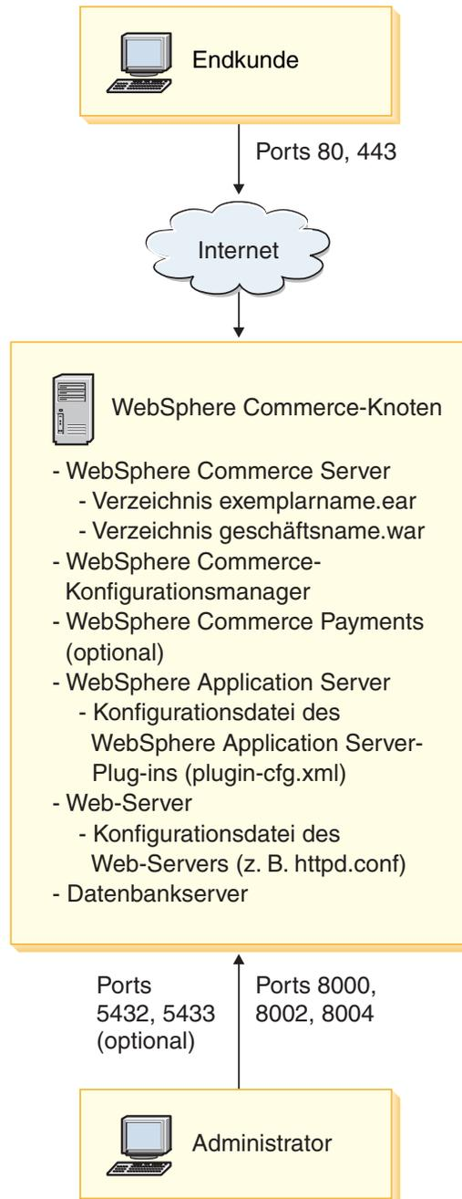
**Anmerkung:** Der Konfigurationsmanager von WebSphere Commerce besteht aus zwei Komponenten: einem GUI-Client und einem Server. Der Server und der Client des Konfigurationsmanagers sind stets auf demselben Knoten installiert wie der WebSphere Commerce Server und WebSphere Commerce Payments.
