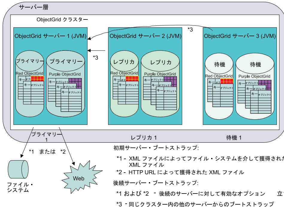
図 3. XML ファイル構成を介した、または既存のサーバーからの初期サーバー・ブートストラップ
