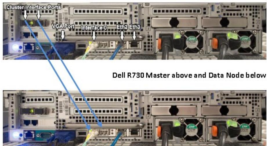
2. En la parte posterior del dispositivo de captura de paquetes, conecte el puerto de interfaz de clúster de la izquierda del maestro con el puerto de interfaz de clúster de la izquierda del primer nodo de datos, tal como indican las flechas de los diagramas precedentes.
