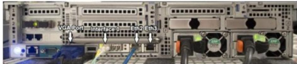
**Importante:** Asegúrese de que haya tráfico por las conexiones. Para capturar tráfico, debe utilizar un puerto Tap o SPAN (duplicado). Cuando utiliza un puerto SPAN en un conmutador, si el conmutador asigna una prioridad menor al puerto SPAN, se podrían eliminar algunos paquetes.
