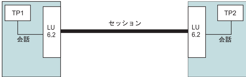
図2. 1つのセッションで行われるトランザクション・プログラムの会話
