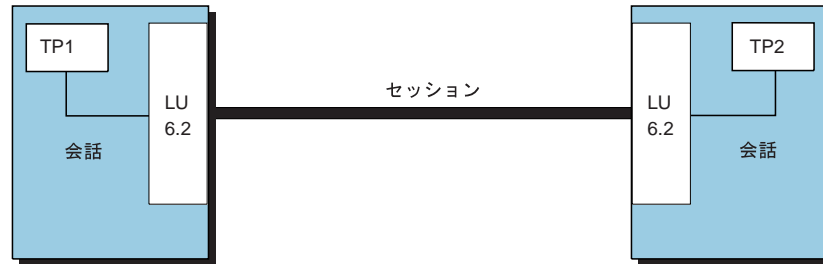
図2. 1つのセッションを介するトランザクション・プログラムVの会話
