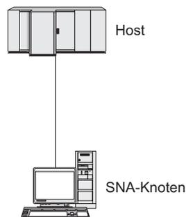
Abbildung 6. CS-Linux-Knoten, der direkt mit einem Host kommuniziert
