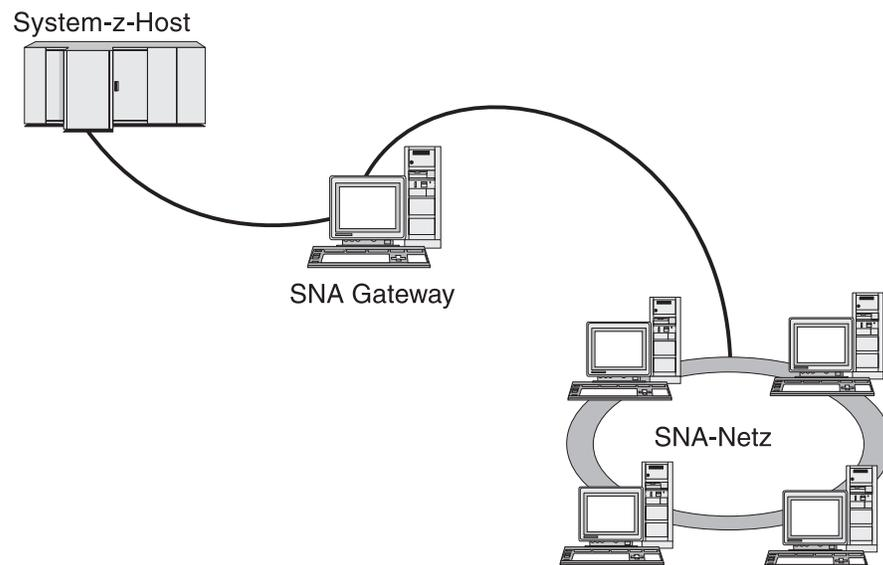
Abbildung 1. Verbindung mehrerer untergeordneter Linux-Computer mit einem Host über SNA Gateway
