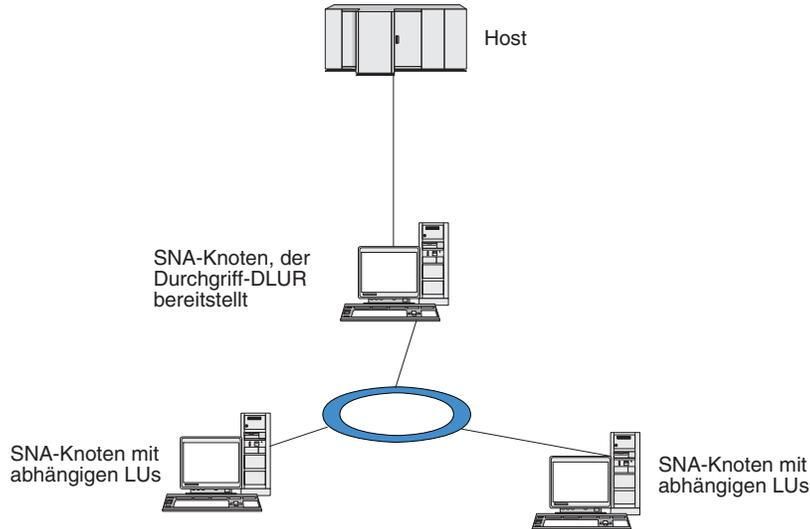
Abbildung 9. CS-Linux-Knoten, der DLUR bereitstellt
