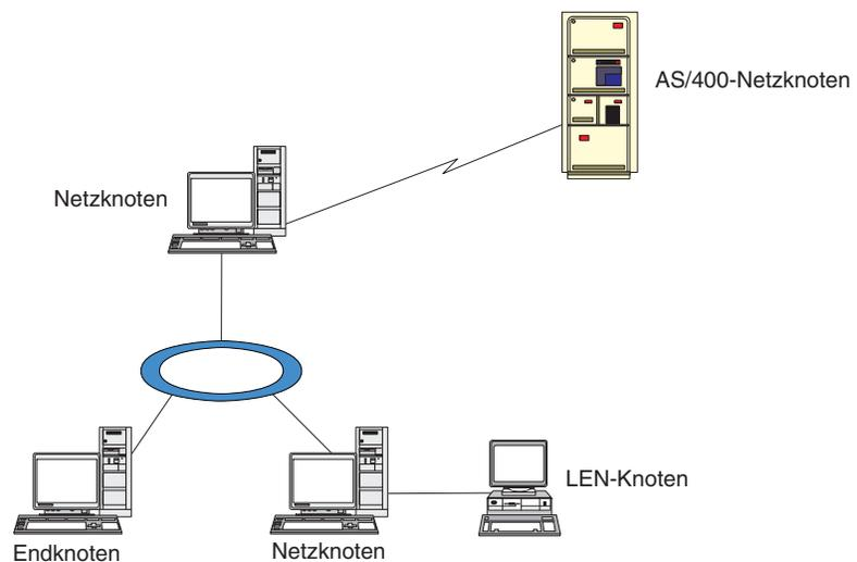
Abbildung 7. CS-Linux-Knoten in einem APPN-Netz
