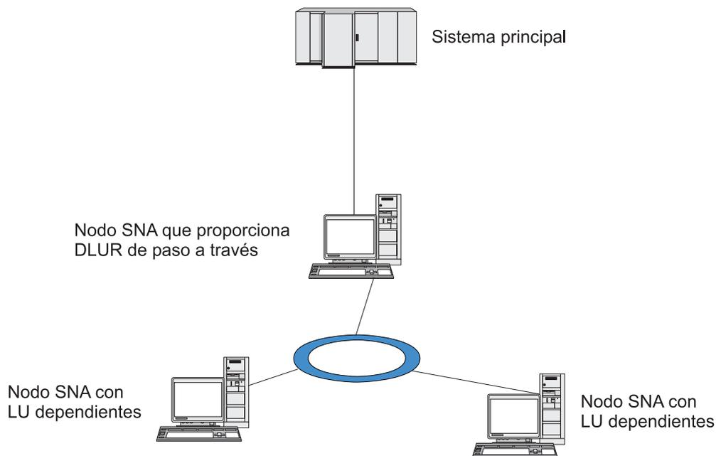
Figura 9. Nodo CS/AIX que proporciona soporte de DLUR
