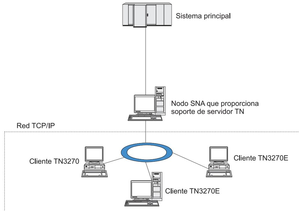
Figura 10. Nodo CS/AIX configurado para el servidor TN
