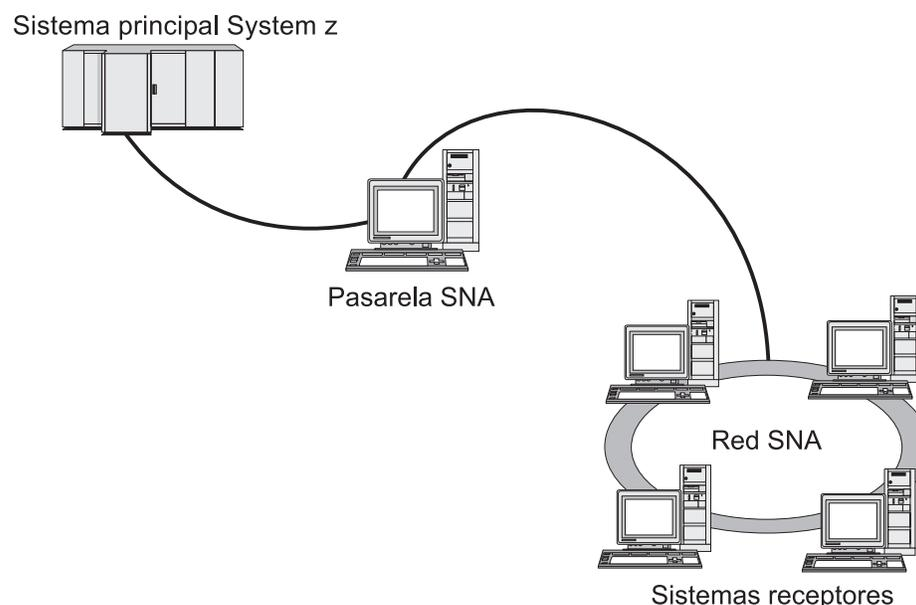
*Figura 1. Pasarela SNA que enlaza varios sistemas AIX en sentido descendente con un sistema principal*
