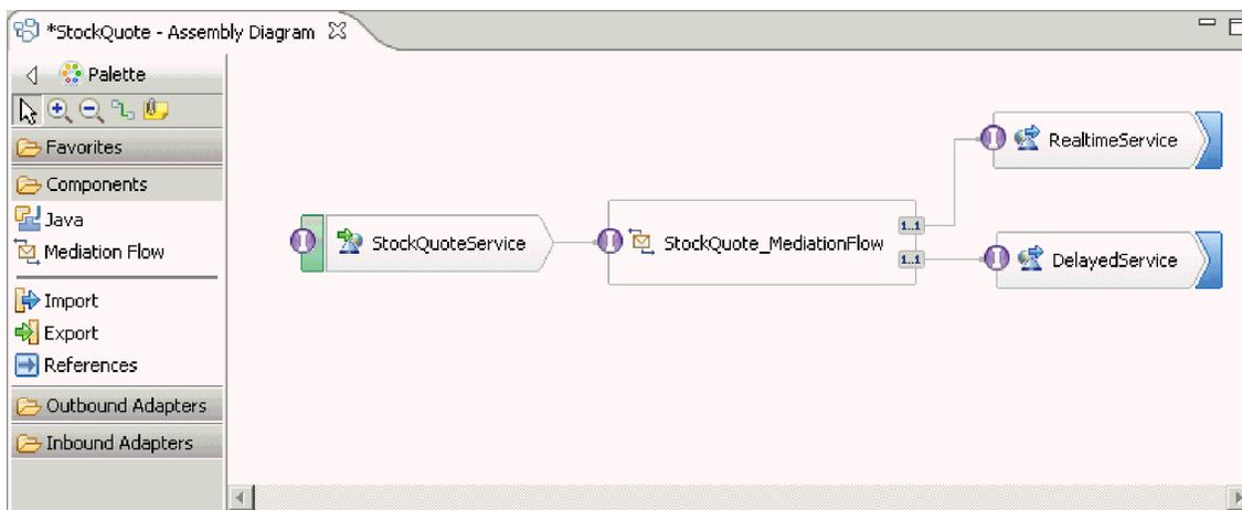
23. Generieren Sie die Implementierung für 'StockQuote\_MediationFlow'. Wählen Sie im Assembly-Editor die Komponente aus, klicken Sie mit der rechten Maustaste und wählen Sie **Implementierung generieren** aus. Wählen Sie den Ordner 'StockQuote' aus und klicken Sie auf 'Ok'. Der Mediationsablaufeditor wird geöffnet und die Quellenschnittstelle und die Zielverweise werden angezeigt.
