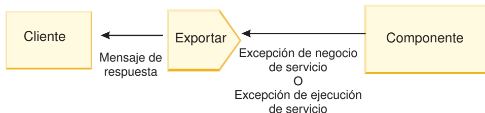
Figura 53. Cómo se envía la información de error desde el componente mediante el enlace de exportación al cliente
