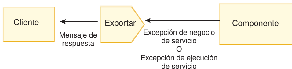
Figura 8. Cómo se envía la información de error desde el componente mediante el enlace de exportación al cliente
