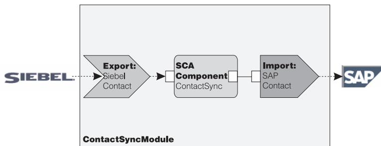
Abbildung 31. Fluss von einem Siebel-System an ein SAP-System
