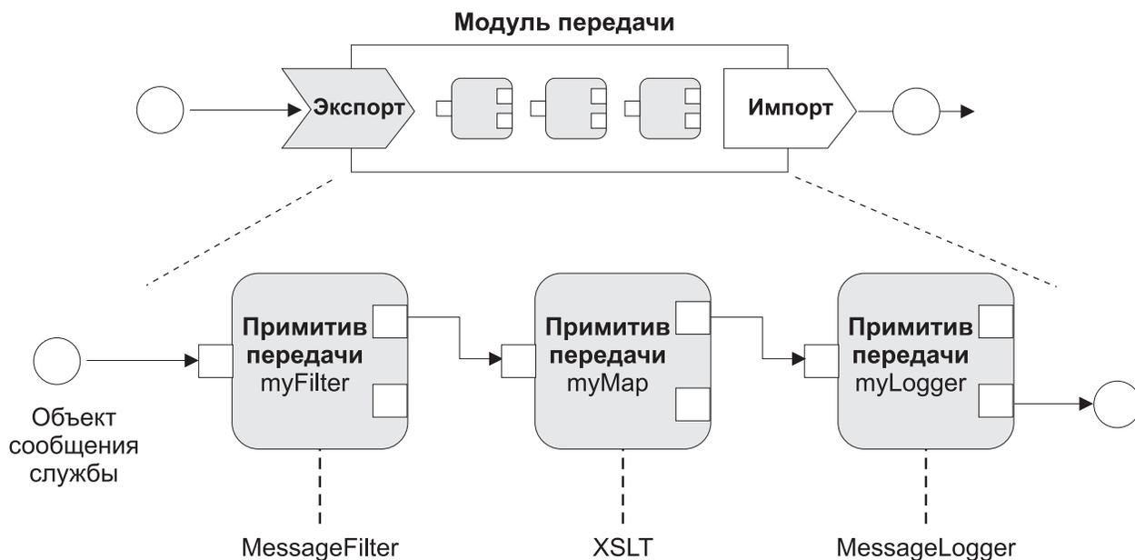
Рисунок 45. Модуль передачи, содержащий три примитива передачи
