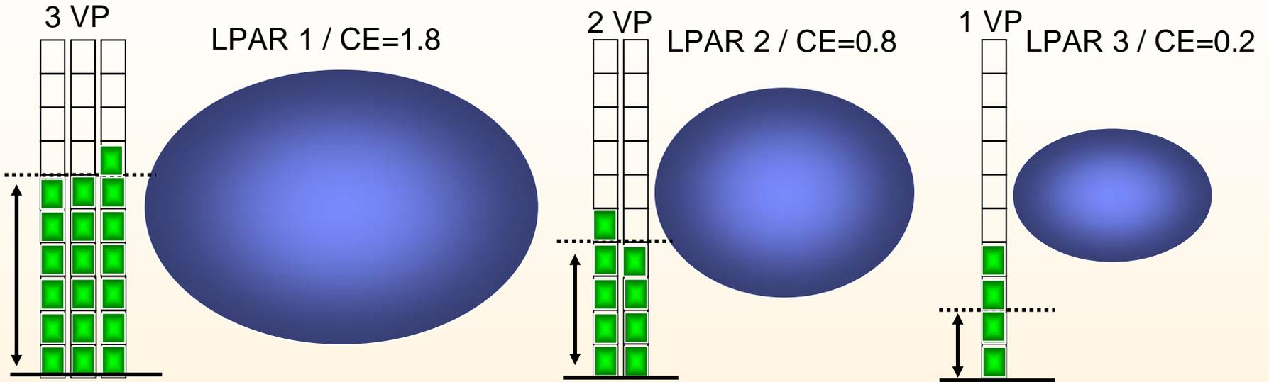
La virtualisation permet de faire varier en temps réel et d'une façon transparente la « puissance d'un processeur »
