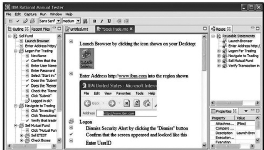
图 1 IBM Rational Manual Tester 是一款手工测试的编写和执行工具，它能够促进测试步骤的重用，从而减少软件变更对测试人员和业务分析员所产生的影响。它使您能够更好地控制和组织手工测试过程，提高应用程序质量测试工作的效率和速度
