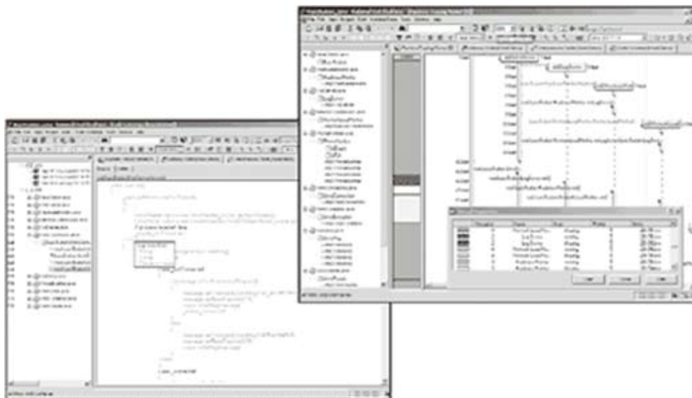
Rational Test RealTime的图形用户界面将您的运行时分析结果(右上——运行时追踪；左下——代码覆盖)和源代码直接超链接，使代码修复无需脱离工具。
