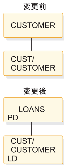
図 125. 論理親、仮想対 - 論理削除規則の例: 削除前および削除後
