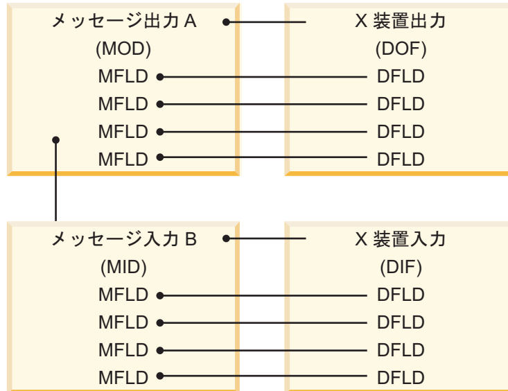
図 24. メッセージ・フィールドと装置フィールドのリンケージ
