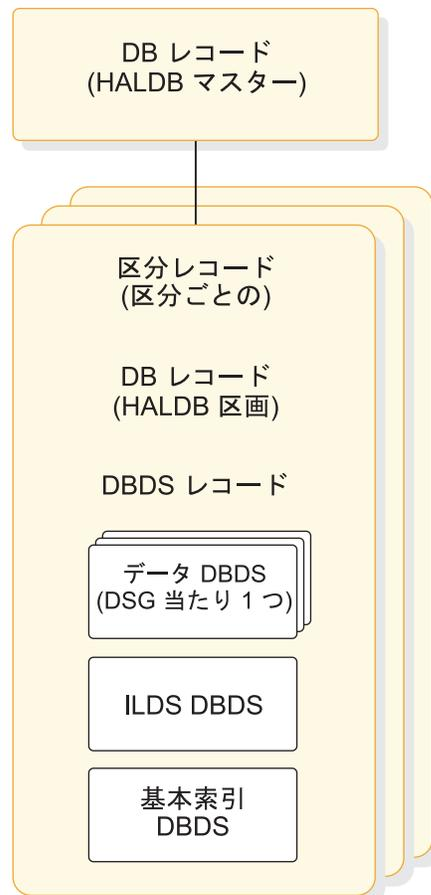
図 58. RECON データ・セット内の HALDB のレコード構造
