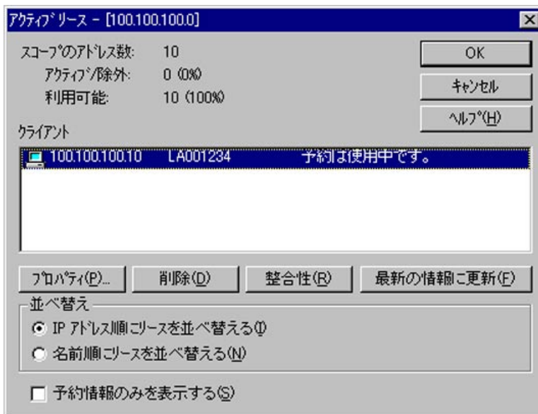
IP アドレスがリースされた状態
