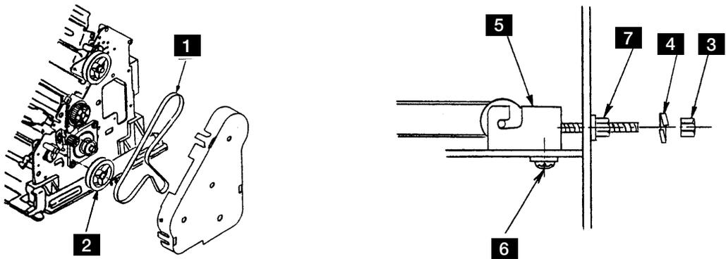
図 6-48. Carrier Belt の張力調整
