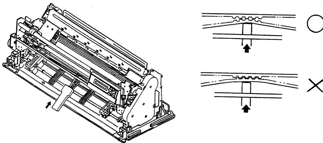
図 6-47. Carrier Belt の張力点検・確認
