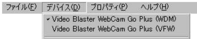
デバイスのサブメニューとして表示されているものは、Windows がイメージング・デバイスとして認識しているデバイスドライバが表示をしています。
