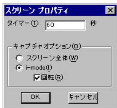
このようにプロパティを設定すると「Desktop On-Call キャプチャー・エンジン」はスクリーン画面を右 90° 回転させて、5x5 に切った画像の断片ファイルを作成します。
