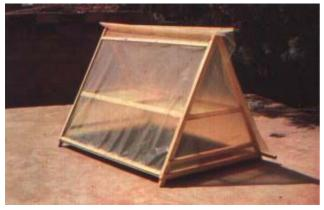
83. Celui-l� est plus simple, sa construction co�te moins cher. Mais le syst�me de s� chage reste le m� me. Premi� rement, le plastique retient la chaleur du soleil et, deuxi� mement, l'air circule � l'int� rieur, entrant par le bas, sortant par le haut.
