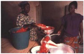
49. Et nous mettons ces tomates ouvertes dans l'appareil qui s'appelle un extracteur. Il sert � extraire la pulpe. Il sert � s� parer la pulpe des graines et de la peau.
