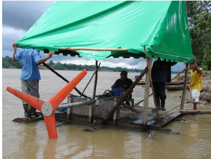
Figure 1: A river current turbine in Peru. Photo: Soluciones Prácticas.
